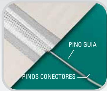
A instalação do pino conector pode ser difícil devido ao seu diâmetro pequeno e à flexibilidade do material. Para facilitar e acelerar este processo, nós oferecemos os pinos líderes que ligam diâmetros menores e pinos rígidos a um diâmetro maior e a pinos conectores flexíveis. O pino líder é facilmente inserido pela fenda, permitindo inserir o pino conector em si. O uso de pinos líderes geralmente reduz o tempo de inserção de pino em mais de 75%
