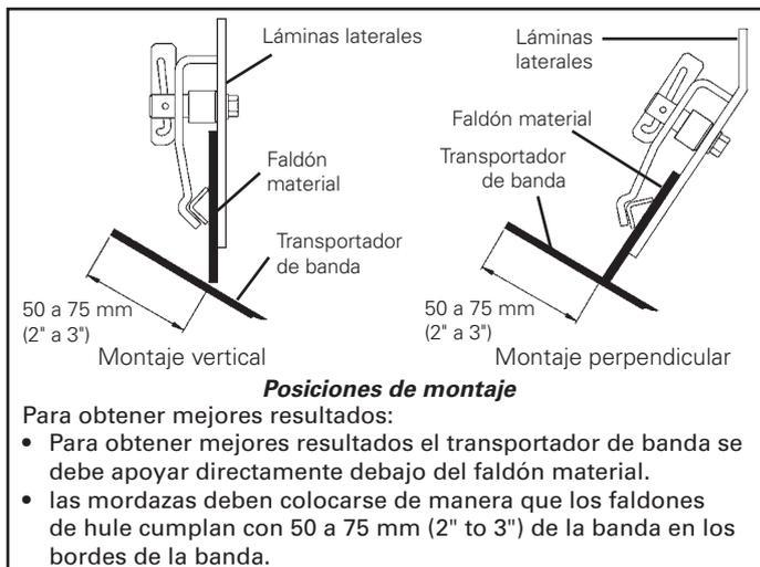
**ETIQUETE Y BLOQUEE FÍSICAMENTE EL TRANSPORTADOR EN LA FUENTE DE ENERGÍA ANTES DE EMPEZAR LA INSTALACIÓN DEL PORTAFALDÓN.**
