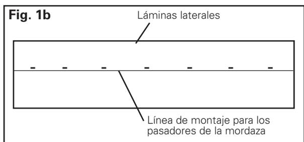
**1. Determine la posición correcta para los pasadores de la mordaza en las láminas laterales.** Mida la altura del faldón material y agregue 6 mm (1/4"). Con esa medida, mida desde la superficie de la banda hasta las láminas laterales y haga una marca (Fig. 1a). Repita esto varias veces hacia las láminas laterales y dibuje una línea que conecte las marcas (Fig. 1b).
