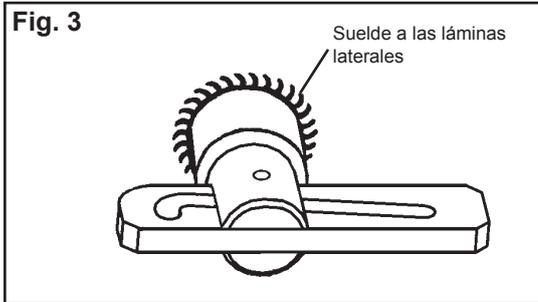
3. **Suelde los pasadores de la mordaza.** Limpie la superficie de las láminas laterales alrededor de las áreas donde se soldarán los pasadores. Suelde la base del pasador con seguridad ya que este es el principal soporte para el portafaldón (Fig. 3). Se recomienda una soldadura de 6mm (1/4") en todo.
