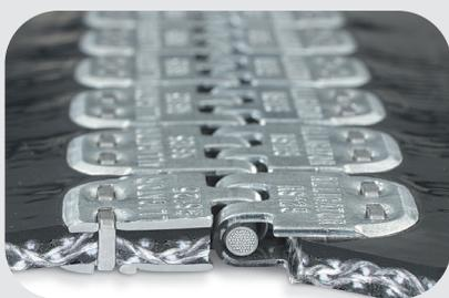
Projetado para correias de carcaça sintética para serviços leves e médios, o grampo Alligator® Staple utiliza um grampo de aço inoxidável de alta resistência, em conjunto com um design de placa estendido. Este projeto separa o ponto de penetração do grampo da linha de flexão da correia para eliminar a fadiga da emenda no ponto de fixação da correia.
