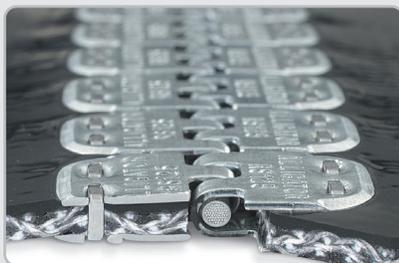
Diseñado para las bandas de almacén sintética de trabajo liviano y mediano, las grapas Alligator® utilizan una alta tensión, fijación de grapas de acero inoxidable, junto con un diseño de placa extendida. Este diseño separa el punto de penetración de la grapa de la línea de flexión de la banda para eliminar la fatiga del empalme en el punto de la fijación de la banda.
