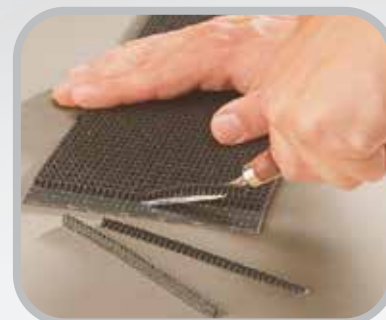
Desbaste la cubierta de impresión.
