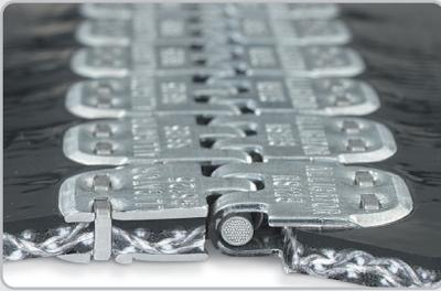
Diseñado para las bandas de armazón sintética de trabajo liviano y mediano, las grapas Alligator® utilizan una alta tensión, fijación de grapas de acero inoxidable, junto con un diseño de placa extendida. Este diseño separa el punto de penetración de la grapa de la línea de flexión de la banda para eliminar la fatiga del empalme en el punto de la fijación de la banda.
