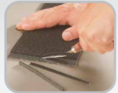
Desbaste la cubierta de impresión.
