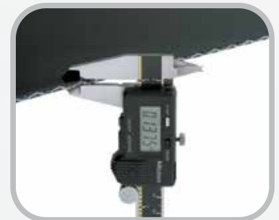
Mida el espesor de la banda.
