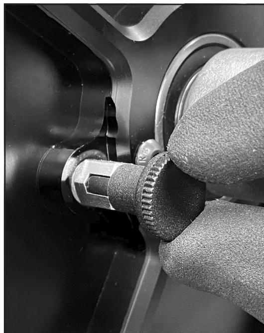
**Schritt 1b** Sicherungsstift eingerastet
