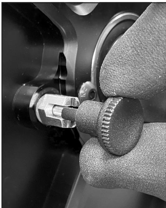
**Schritt 1a** Sicherungsstift gelöst
