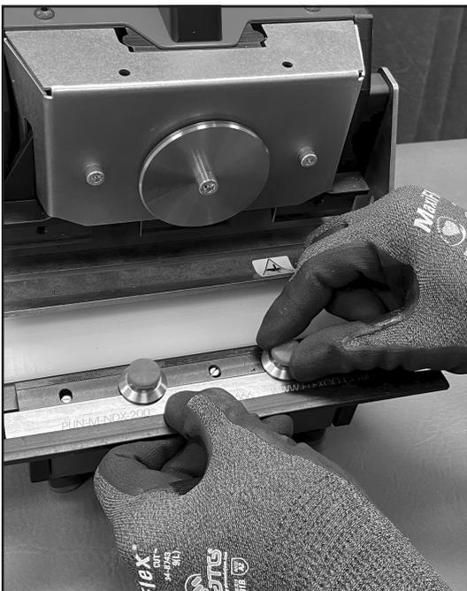
**Schritt 9** Rändelschrauben anziehen
