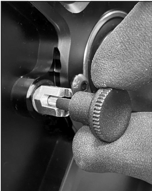
**Schritt 12a** Sicherungsstift gelöst
