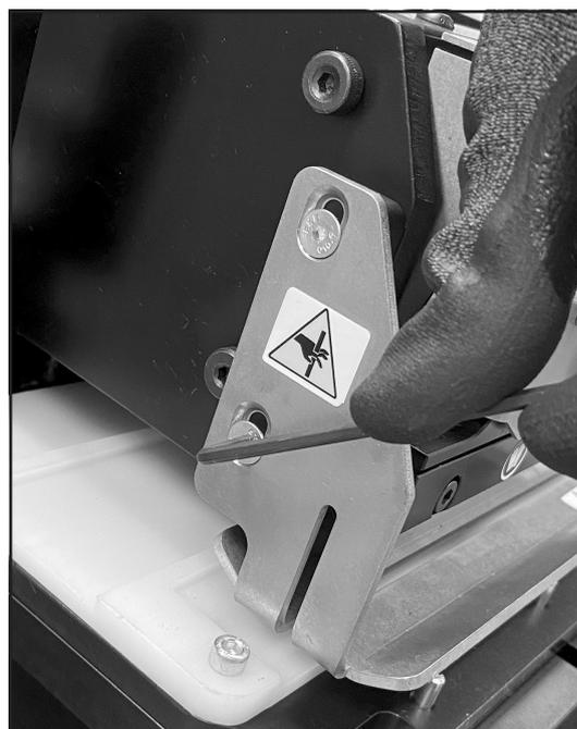
**Schritt 2** Platte der Schutzvorrichtung
