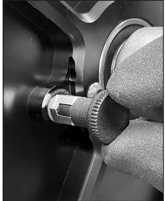
**Schritt 7b** Sicherungsstift eingerastet
