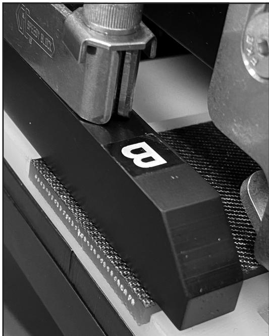
Schritt 3a Band bündig mit Kante bei Klemme B
