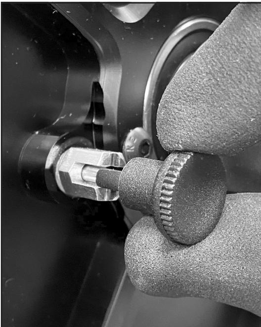
**Schritt 2a** Sicherungsstift gelöst
