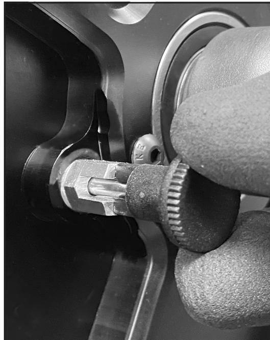
**Schritt 10b** Sicherungsstift in der Selbsthaltestellung
