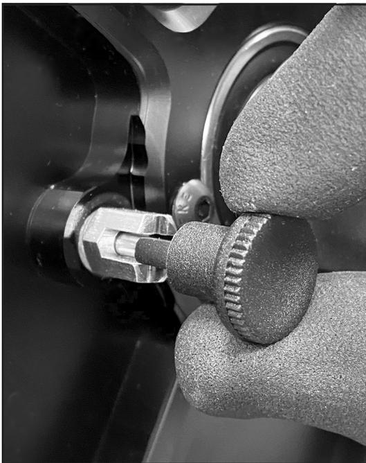
Schritt 1a Sicherungsstift gelöst
