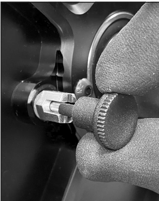
Schritt 2a Sicherungsstift gelöst
