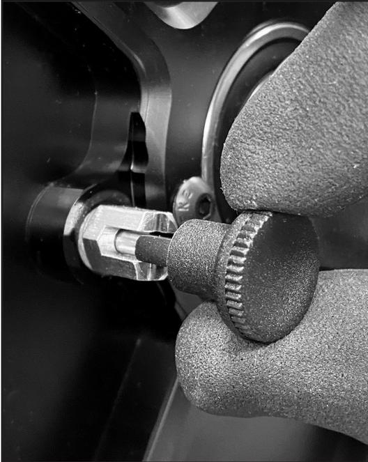
**Schritt 7a** Sicherungsstift gelöst
