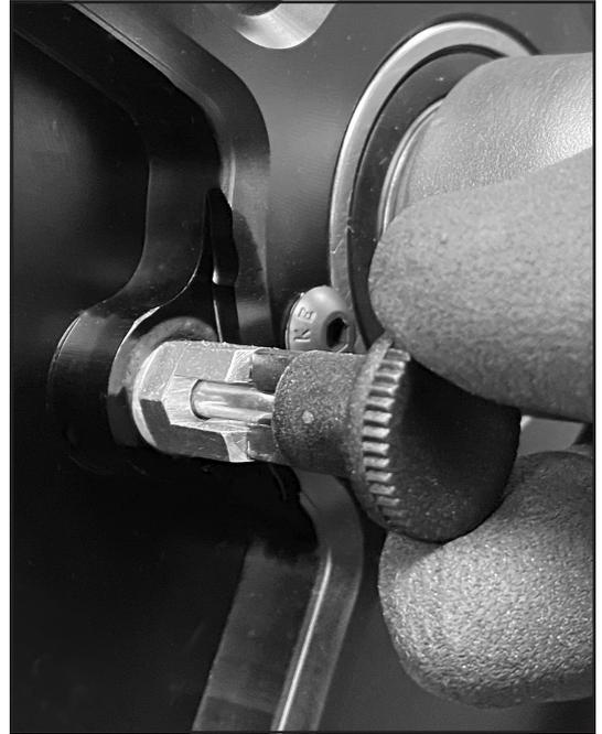
**Schritt 4b** Sicherungsstift in der Selbsthaltestellung
