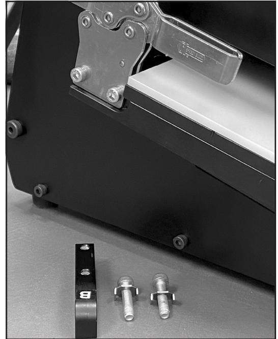
**Schritt 1b** Klemme und Schrauben entfernt
