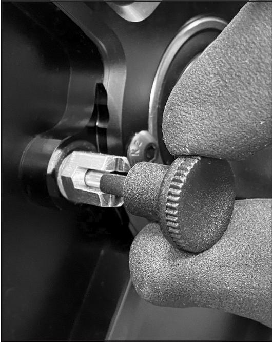
**Schritt 4a** Sicherungsstift gelöst
