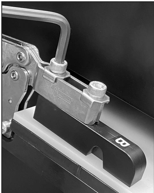
**Schritt 1** Schrauben lösen
