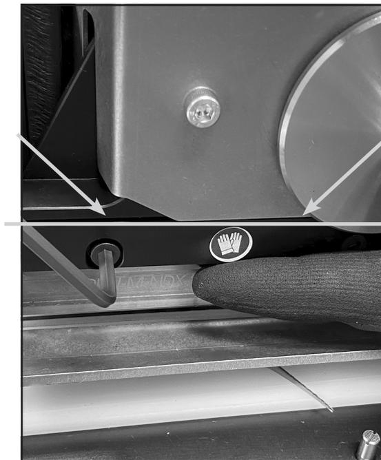
**Schritt 6** Schrauben etwas lösen
