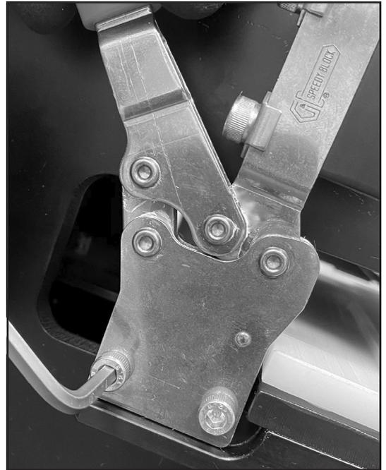
**Schritt 2** Bandklemmen-Grundplatte lösen
