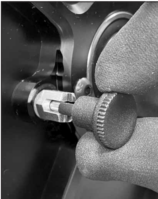
Schritt 2a Sicherungsstift gelöst
