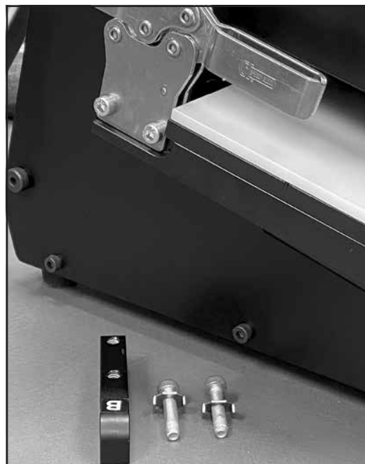
Schritt 1b Klemme und Schrauben entfernt
