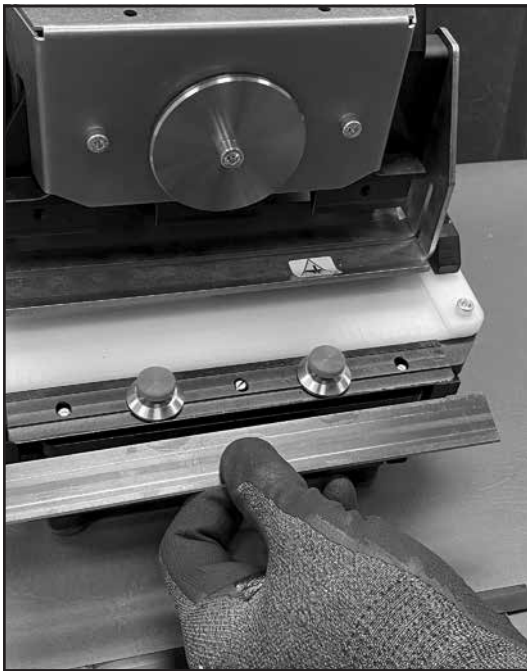
Schritt 7 Klinge entfernen
