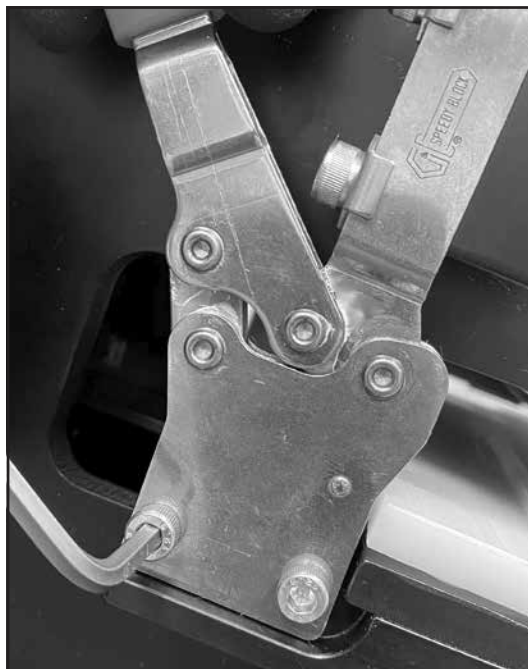
Schritt 2 Bandklemmen-Grundplatte lösen
