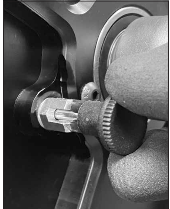
Schritt 10b Sicherungstift in der Selbsthaltestellung
