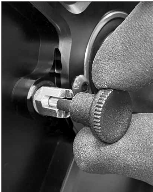
Schritt 4a Sicherungsstift gelöst
