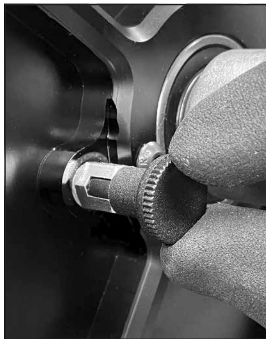
Schritt 1b Sicherungsstift eingerastet
