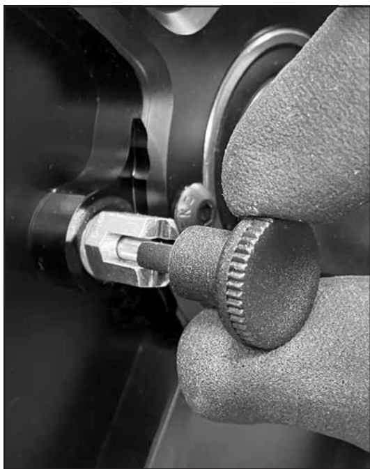
Schritt 1a Sicherungsstift gelöst
