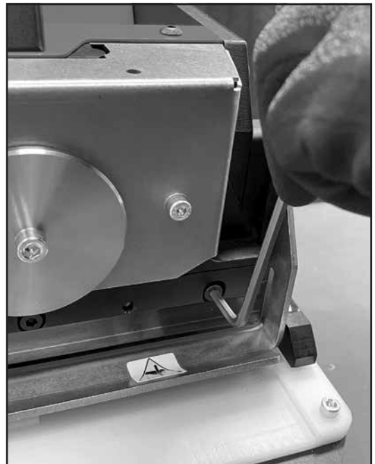
Schritt 2 Schrauben lösen
