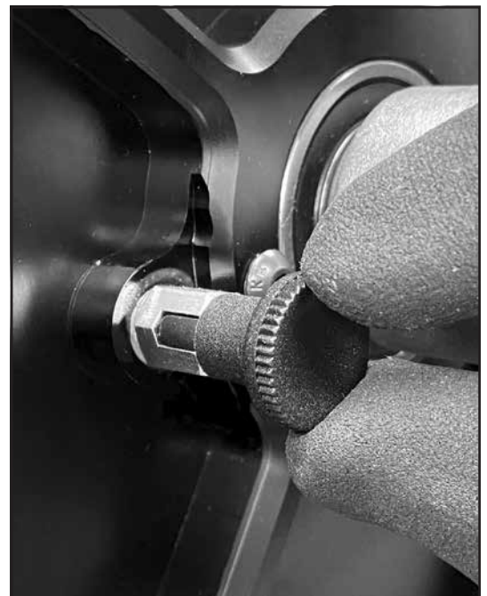
Schritt 2b Sicherungsstift eingerastet
