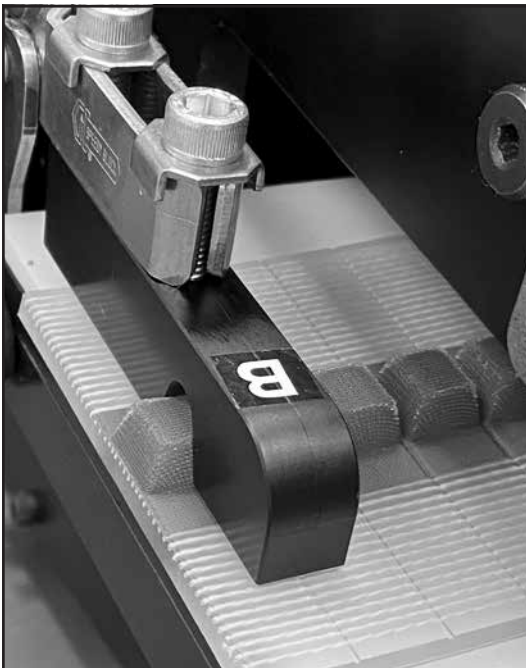
Schritt 3c Band in der letzten V-Profil-Kerbe geklemmt
