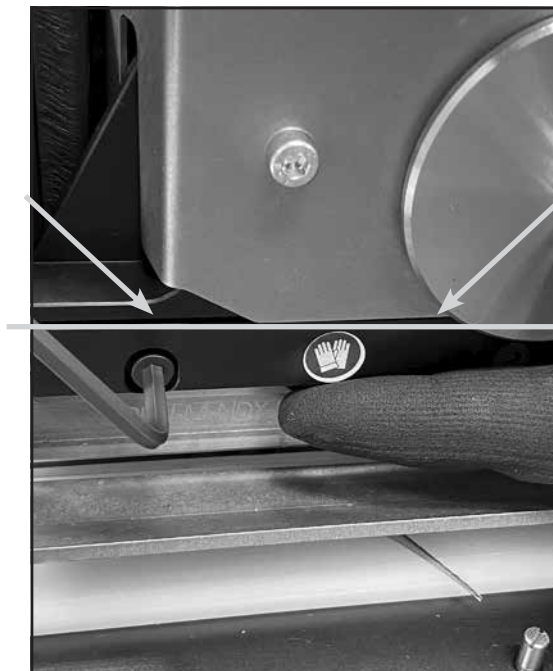
Schritt 6 Schrauben etwas lösen
