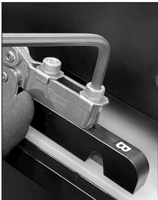
Schritt 1a Schrauben lösen
