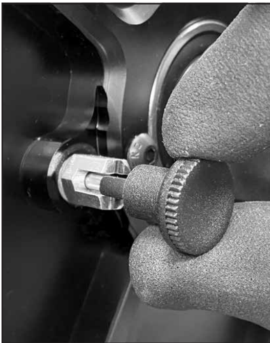
Schritt 1a Sicherungsstift gelöst
