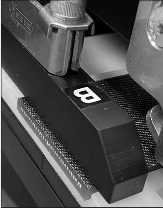
Schritt 3a Band bündig mit Kante bei Klemme B
