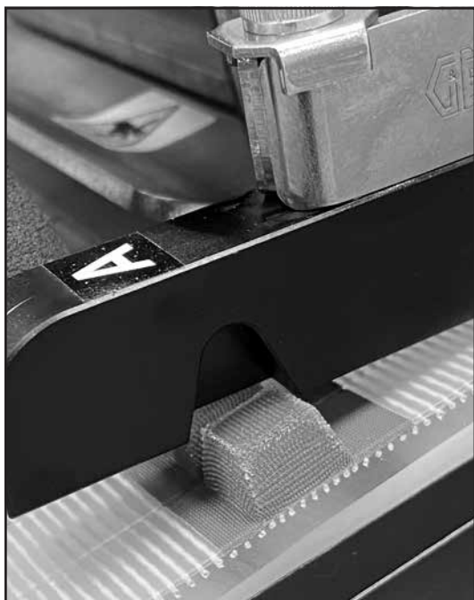
Schritt 9c Band in der letzten V-Profil-Kerbe geklemmt
