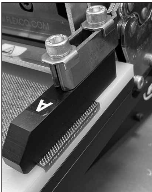
Schritt 9a Band bündig mit Kante bei Klemme A
