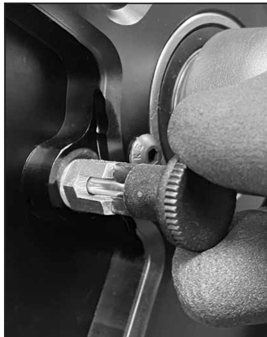
Schritt 4b Sicherungsstift in der Selbsthaltestellung
