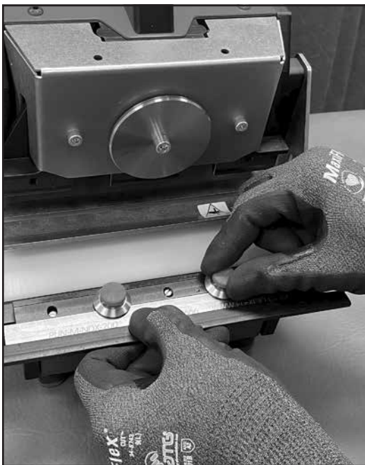
Schritt 9 Rändelschrauben anziehen
