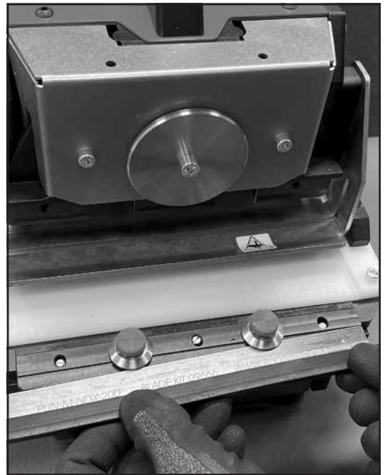
Schritt 8 Klinge einsetzen
