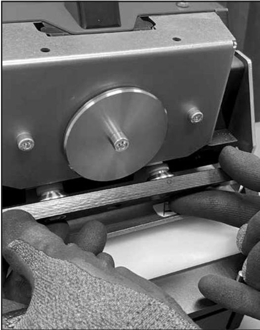
Schritt 11a Klingenhalter positionieren
