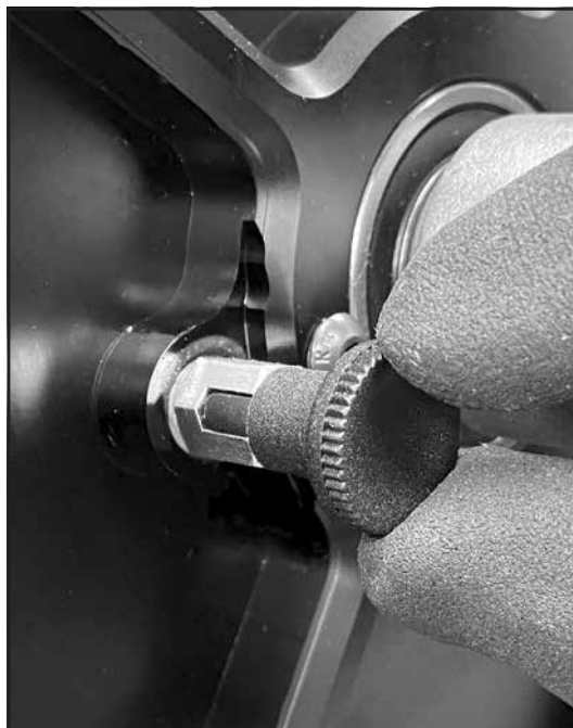
Schritt 12b Sicherungsstift eingerastet
