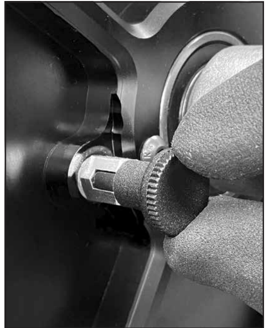
Schritt 7b Sicherungsstift eingerastet
