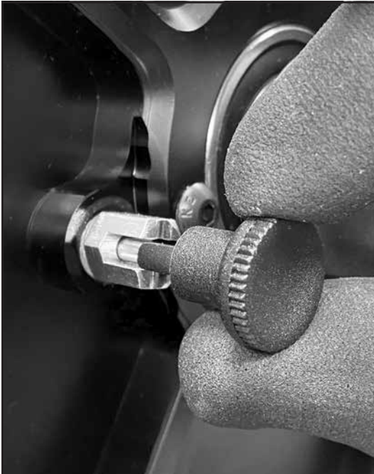
Schritt 10a Sicherungstift gelöst
