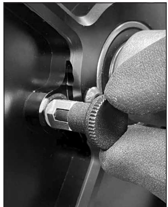
Schritt 1b Sicherungsstift eingerastet
