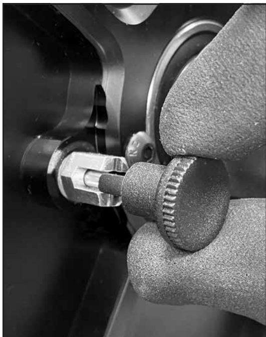
Schritt 12a Sicherungsstift gelöst
