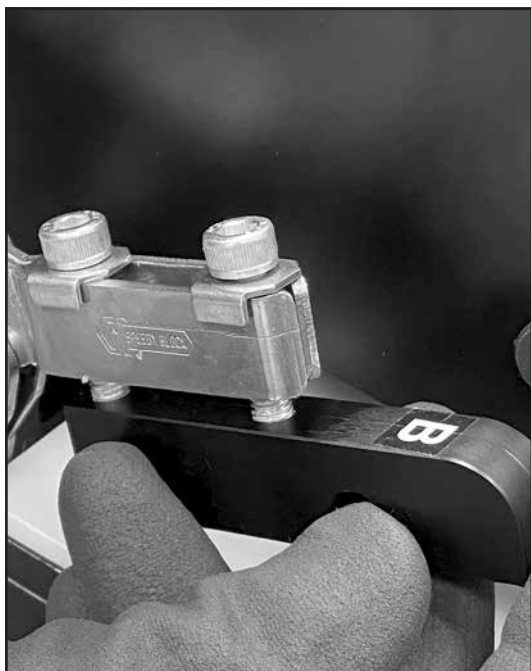
Schritt 3 Schrauben eindrehen
