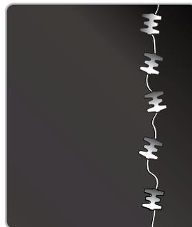
对于临时快速维修，建议沿裂口每隔 101 至 152 mm (4" 至 6") 使用手锤安装的 Turtle (TM) 16 号带扣。
