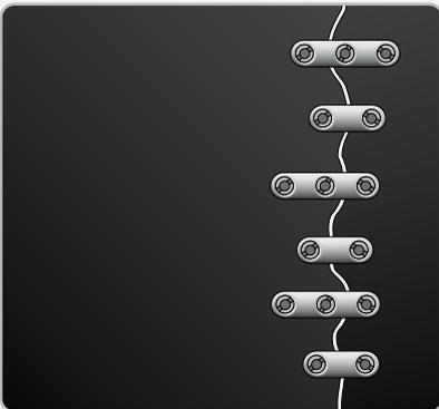
对于锯齿状纵向输送带撕裂或可能撕裂的“柔软位置”，可结合使用标准的螺栓板式带扣和三螺栓撕裂修复带扣。
