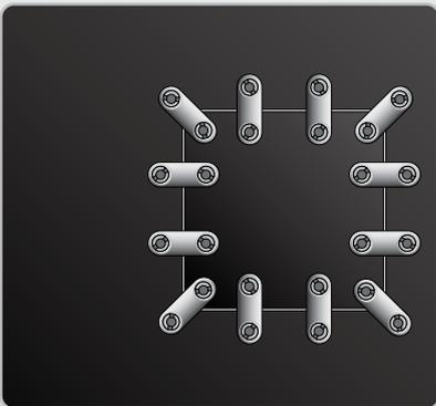
可使用标准的 Flexco® 板式带扣搭配一片输送带有效地修复较大的孔洞，如图所示。
