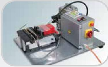
El ARK-150-WNP hidráulico y eléctrico ofrece la metodología más rápida y sencilla para la instalación de grapas de parche. La grapa incluye tanto una estación de enfriamiento como una estación de presión/calefacción
