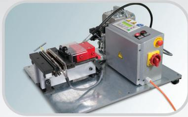
Die elektro-hydraulische Einpressmaschine ARK-150-WNP bietet die schnellste und einfachste Möglichkeit, die Patch-Verbinder einzupressen. Die Einpressmaschine beinhaltet sowohl eine beheizte Einpresszone als auch eine nicht beheizte, kühlere Nachpresszone.
