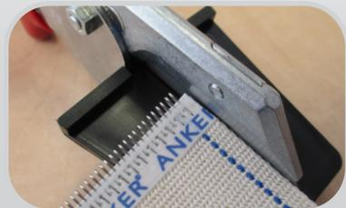
Bandtrimmzangen können zum Schneiden der Bandenden verwendet werden und zum Einkerben der Ecken bei montierten Patchverbindern, um zu verhindern, dass die Ecken während des Betriebs anstossen und ausreißen.
