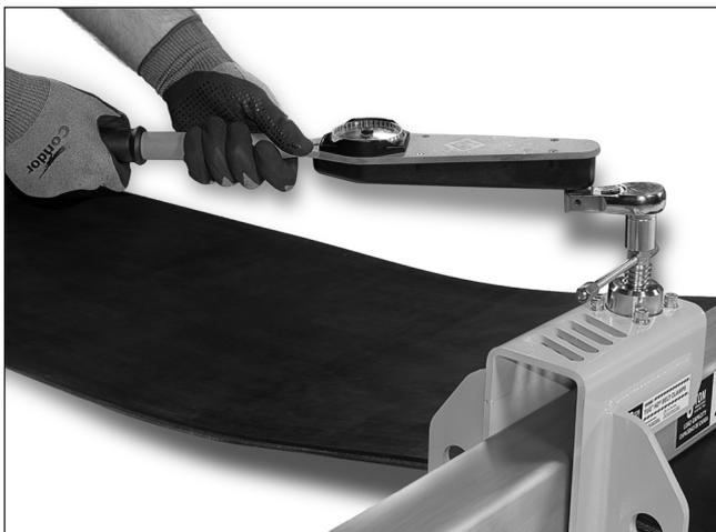
5. 使用20 mm六角头扭矩扳手将正确的扭矩值施加到夹头螺钉上。
