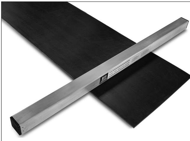
1. 将顶杆放置到位，确保与皮带边缘成90°角。
