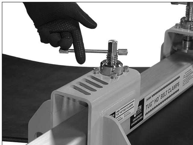
4. 使用T形手柄将夹头螺钉快速拧紧皮带。请勿锤击T型手柄以拧紧夹头。请勿使用T型手柄完全拧紧夹头螺钉。他们会弯曲。
