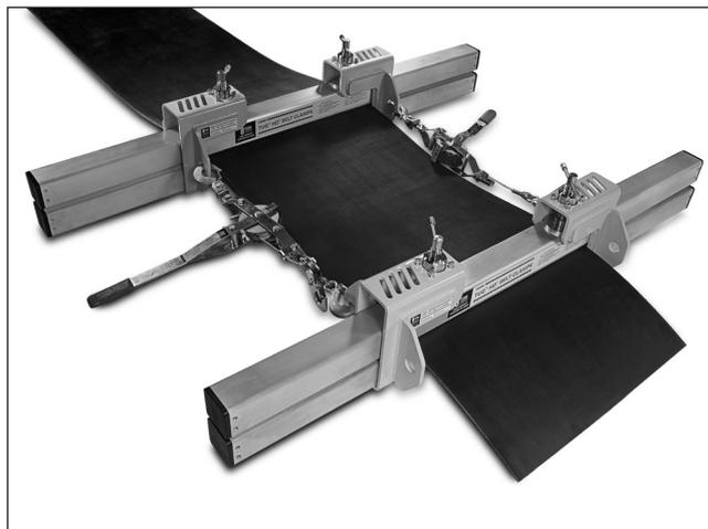
6. 使用挂钩安全门锁将拉紧部件牢固地连接到夹头上。均匀施加张力将皮带拉到所需位置。
