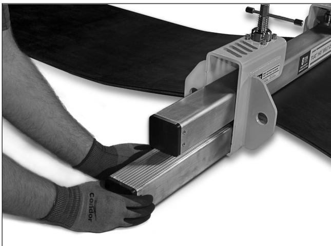
3. 将底夹杆滑入夹头并在皮带下。确保每个夹杆上的夹紧图案都朝向皮带表面。
