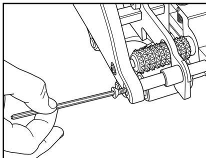
2. 将工具转到另一侧。使用六角扳手卸下两个手柄固定螺钉。从工具上卸下手柄。
