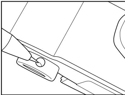
8. 将驱动轴上的孔与链轮孔对齐。
