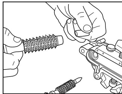
6. 从新的备用驱动轴上卸下大的固定盖。把旧驱动轴取下的垫片装到新的驱动轴上。
