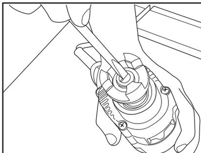
2. 顺时针方向旋转连接外壳联轴器的左手螺纹螺丝，将左手螺纹螺丝卸下。
