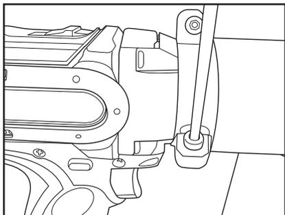
1. 从电源上拔下电钻插头。卸下三颗螺钉（使用4毫米六角扳手），从外壳上拆下电钻。
