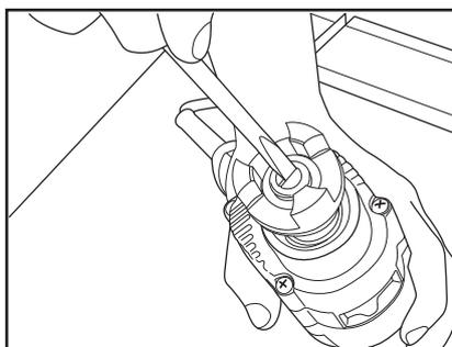
5. 涂抹Loctite®乐泰螺纹胶，插入左手螺纹的螺丝，然后逆时针方向拧紧，将联轴器固定到电钻上。
