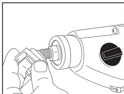
4. 将内螺纹联轴器拧到新的电钻轴上。
