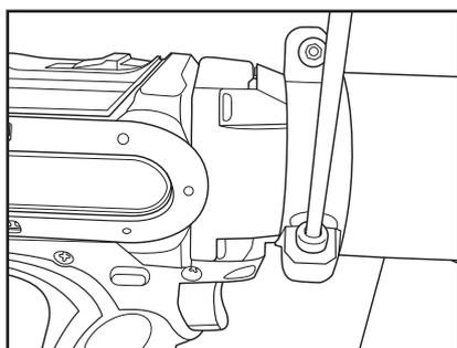
9. 涂抹乐泰胶到三个螺丝上，安装拧紧螺丝，将电钻固定到位。
