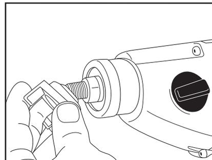
3. 从旧电钻的轴上，拧下内螺纹的联轴器。
