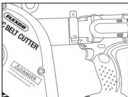
7. 将钻头插入外壳，确保对准联轴器。为了使联轴器正确啮合，在外壳颈部和电钻套管之间不应留有间隙。在安装最后的螺丝之前，请确定钻头在工作并且刀片在旋转。
