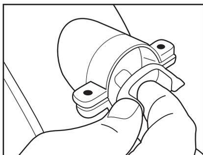
6. 确保联轴器和黑色橡胶“蜘蛛”（原始装置的一个部件）放置在外壳中，并且键和键槽已啮合。
