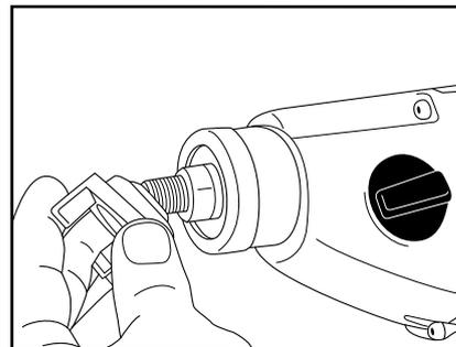
3. 从旧电钻的轴上，拧下内螺纹的联轴器。
