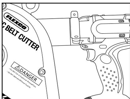
7. 将钻头插入外壳，确保对准联轴器。为了使联轴器正确啮合，在外壳颈部和电钻套管之间不应留有间隙。在安装最后的螺丝之前，请确定钻头在工作并且刀片在旋转。
