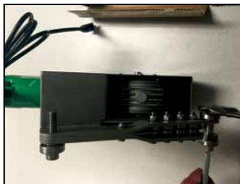
步骤1. 用8毫米或5/16英寸六角扳手和17毫米套筒端/月牙扳手松开现有的滑轨锁紧螺母。把锁紧螺母，轴承和垫圈放在旁边。
