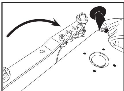
7. 小心地将支架重新旋转到位。当刀片在皮带支撑轴承之间滑动时，请小心不要损坏刀片。
