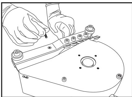
8. 装回支架支撑螺栓。拧紧支架后部螺栓。
