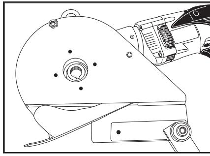
6. 小心地更换刀片垫片，然后将新刀片滑入外壳。在刀片，垫片和齿轮箱中对准键槽，然后插入刀片安装轴。
