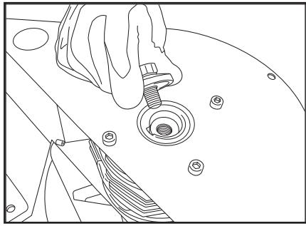
4. 卸下刀片安装螺栓。
