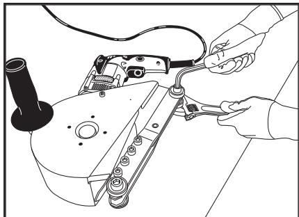
1. 从电源上拔下电钻插头。松开支架后部螺栓。
