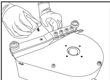
2. 卸下支架支撑螺栓和螺母。
