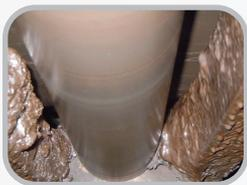
A combinação de material composto avançado permite que materiais descartados caiam do rolete, evitando acúmulo de material e danos à correia.
