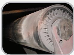
A vedação centrífuga foi projetada para proteção, evitando que materiais presos danifiquem o disco de extremidade que, geralmente, resulta em falha prematura do rolete.
