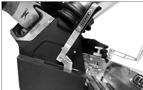
b. Das Werkzeug kräftig nach rechts schieben, bis das Werkzeug fest auf dem Bett sitzt.
