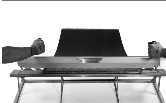
d. Das Band in dieser Position sichern, indem die Klemmbalkengriffe an beiden Enden der Klemmbalken angezogen werden, bis das Band sicher verklemmt ist.
