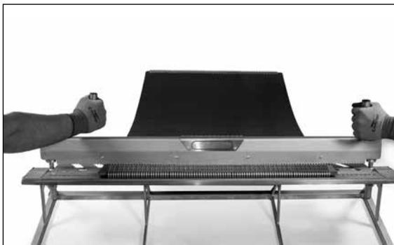
d. 均匀调节夹杆两侧的夹杆手柄直到牢固地夹紧输送带，将输送带固定在此位置。
