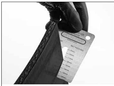
c. 如果没有输送带样本，可以使用独立的输送带测厚计作为备选方案。参考测厚计上的输送带厚度参考数值并对带扣压紧旋钮做相应的调整。
