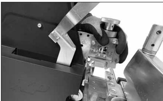
a. 将钉扣工具上的安装架滑入带扣座轨道左端以将钉扣工具连接到带扣座上。确保操作手柄位于前向位置“0”。
