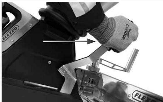
b. 向前推操作手柄（位置“0”）。此操作会完成驱动循环。完成循环时间约为两秒。
