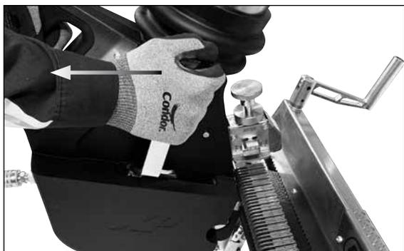
a. 将操作手柄从位置“0”移到行程末端（位置“2”）。此操作会导致发生以下一系列事件：推进钉扣工具到下一个带扣，下压顶板，嵌入针脚，将针脚折弯成型。将手柄按在位置“2”直到感受到手柄的反馈。
