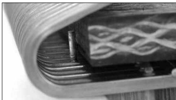
b. 将输送带末端推进带扣中直到它紧挨带扣中的输送带挡板。如果输送带末端移动到输送带挡块上方，将输送带回拉使其正确对齐。
