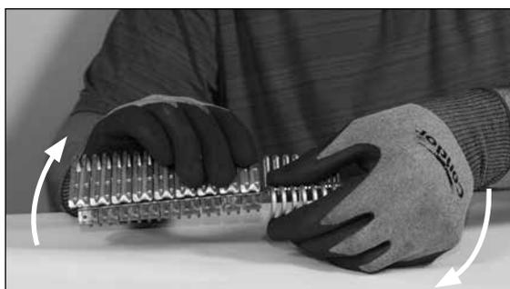
b. 如果需要短一点的带扣，一只手固定带扣，另一只手小心地上下掰带扣。放在钉扣机带扣座上之前，处理掰短的带扣末端的焊点，使焊点与带扣末端持平。
