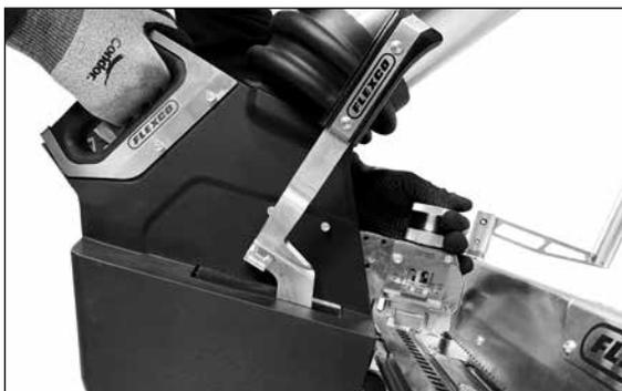
b. 沿导轨将钉扣工具整个推入带扣座，使其稳定。
