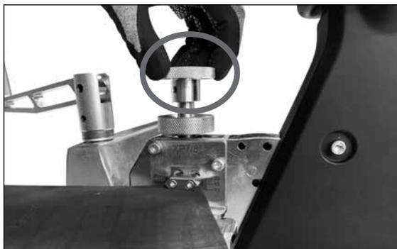
b. 调整带扣压紧旋钮直到输送带刚好滑入测厚计开口。顺时针旋转拧紧。逆时针旋转松开。
