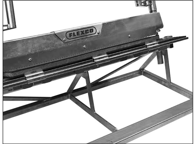
1. 选择与带扣尺寸相对应的输送带挡块。将挡块滑到带扣座上，在整个输送带宽度上间隔均匀地放置。将输送带末端居中插入钉扣机架的带扣座中，直至其抵靠所有输送带挡块。拧紧夹杆。
