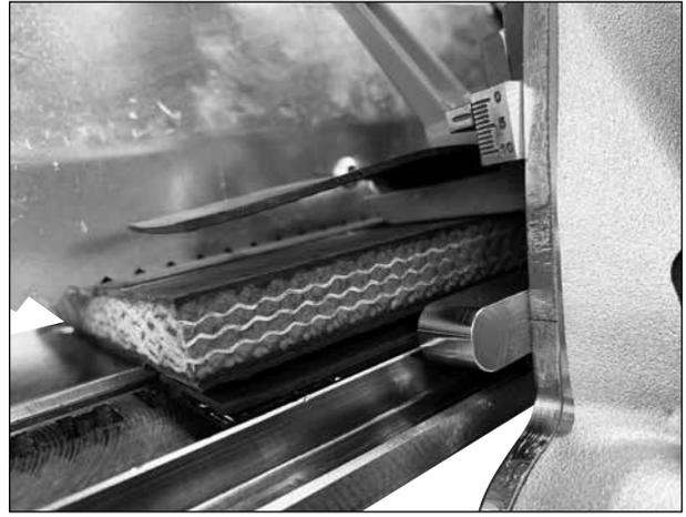
4. 顺时针转动操作手柄开始去皮。确保切割废料不会造成去皮器堵塞。在输送带上喷洒硅油将减少去皮时的阻力。如果阻力过大，请停止并反向操作，然后检查部件是否松动或损坏。
