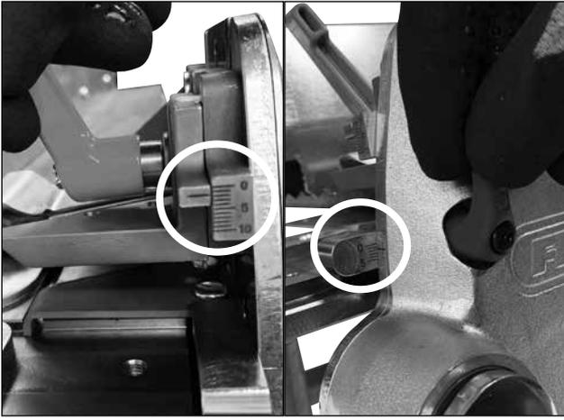
3. 将下刀片固定装置和上刀片固定装置调整到所需的切割深度。去皮前，确保上刀片调整手柄处于向上位置。
