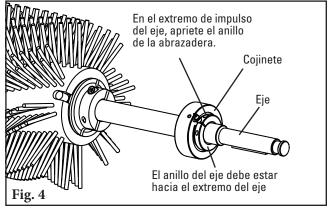
5. Instale el ensamble completo del eje en los soportes de ajuste. Coloque el cojinete que está en el extremo de impulso del eje en el soporte de ajuste del lado del transportador donde montará el motor. Coloque el cojinete en el extremo no de impulso del eje en el otro soporte de ajuste. Asegúrese de que el engrasador zerk estén girados y que no interfieran con los soportes de ajuste (Fig. 5).
