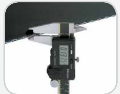
测量输送带厚度。
