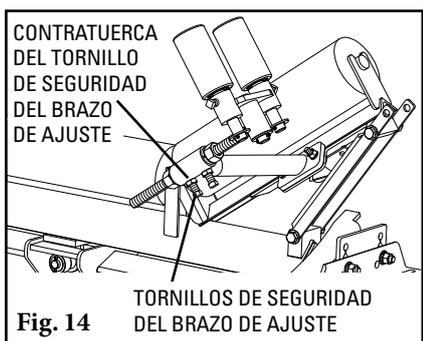
**17. Bloquee los brazos de ajuste en su lugar (Fig. 14).** Una vez que se establece y confirma la ruta de alineación, afloje la contratuerca del tornillo de seguridad del brazo de ajuste y apriete los tornillos de bloqueo del brazo de ajuste. Vuelva a apretar la contratuerca del tornillo de seguridad del brazo de ajuste. Repita en el lado opuesto.
