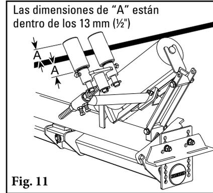
**16. Revise la ubicación del recorrido de la banda en la superficie de los rodillos sensores.** Para obtener los mejores resultados, la línea del recorrido de la banda debe estar centrada en la superficie de los rodillos sensores a 13 mm (1/2") (Fig. 11).
