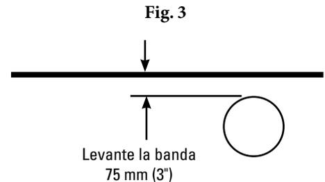
4. Levante la banda donde se instalará el alineador. En el sitio donde se instalará el alineador, levante la banda 75 mm (3") de los rodillos que va a reemplazar (Fig. 3). **PRECAUCIÓN:** Es posible que necesite algunas herramientas o equipo de elevación dependiendo del peso de la banda.
