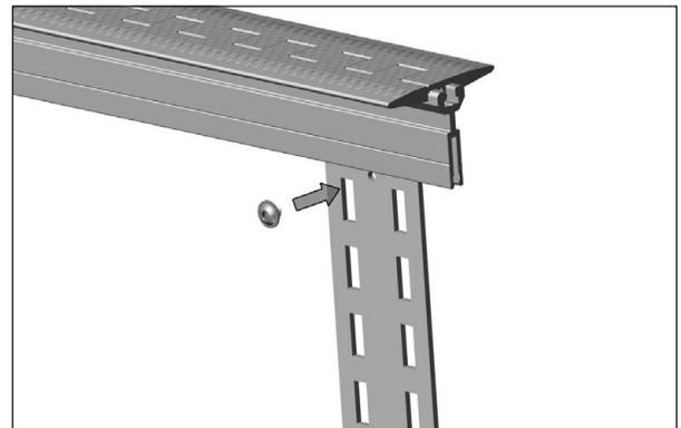
5. Utilice un tornillo de cabeza de botón para fijar ligeramente el soporte vertical a la barra de soporte extruida.
