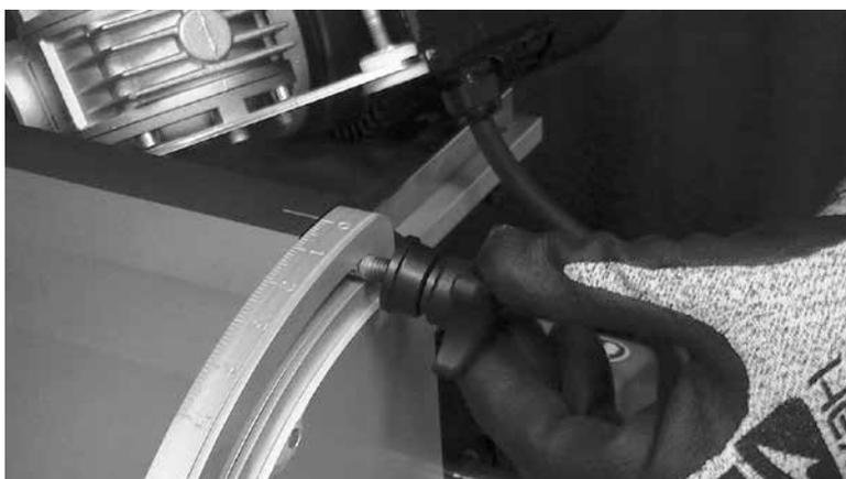
その後クランプナットを再び取り付けます。
