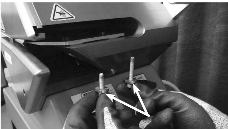
真鍮製スペーサーが Ply フレーム内またはボルト上にあるか確認します。ブレードのシフトがまだできる程度までボルトを指で締めます(背面の長いボルトと前面の短いボルト)。
