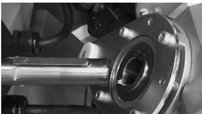
モーターを再び取り付けます。シャフトキーをキースロットの位置に合わせます。
