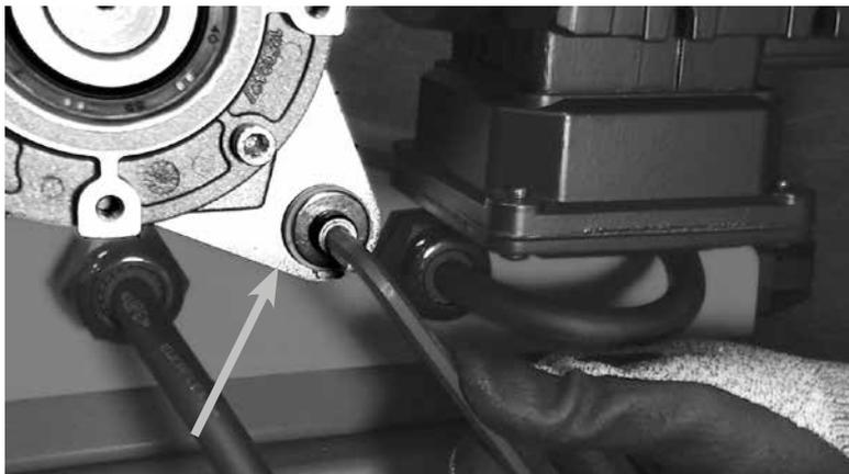
最初に 6 mm 六角レンチを使用してトルクアームボルトを外して電気モーターを取り外し、牽引ローラー調節のための十分なアクセス経路を確保します。
