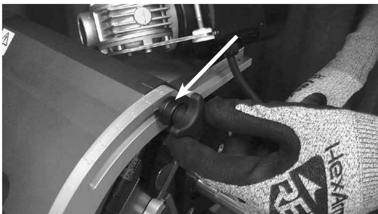
調整ネジにアクセスできるように、調整ハンドルを配置しロックします。
