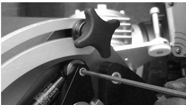
上部ローラーを調節するには、ガスプリングを留めるネジを緩め外します。
