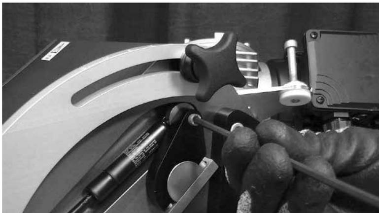
ガススプリングネジを再度取り付けます。
