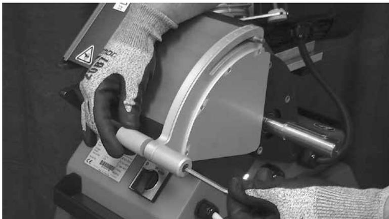
調整が終わったら、ガードプレートを再設置します。ハンドルの再設置を開始します。
