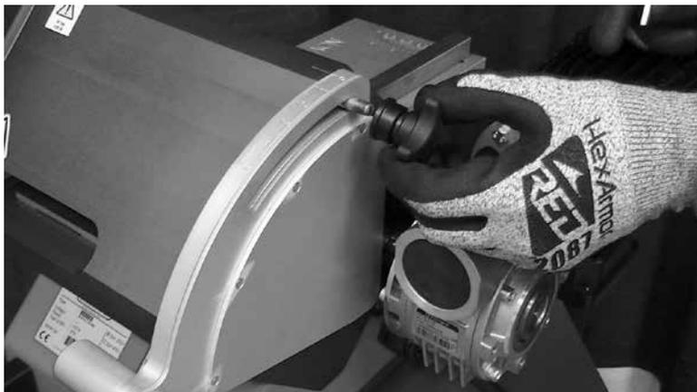
調整が必要な場合は、調整ガードプレートのクランプナットを緩めます。
