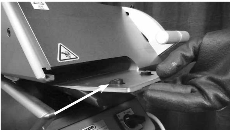
斜角が牽引ローラー側を向くようにナットを差し込みます。
