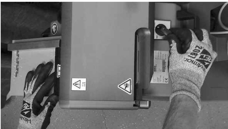
電源コードをコンセントに差し込みます。スイッチを「逆方向 (REVERSE)」に切替え、ジグを牽引ローラーから解除します。
