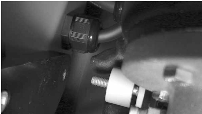
Vuelva a ensamblar el motor al marco colocando el espaciador entre el brazo de torsión del motor y la base de capa. Inserte el tornillo hexagonal de 8 mm con la arandela y apriete.
