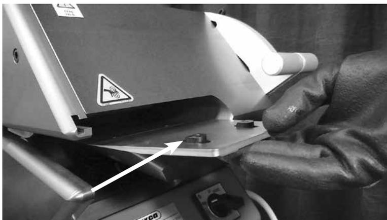
Inserte las tuercas de manera que los biselados queden colocados hacia los rodillos de tracción.
