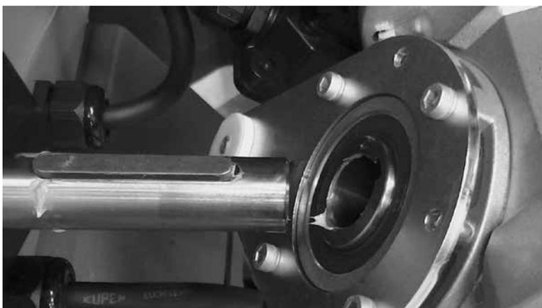
Vuelva a instalar el motor. Alinee la chaveta del eje con la ranura de chaveta.
