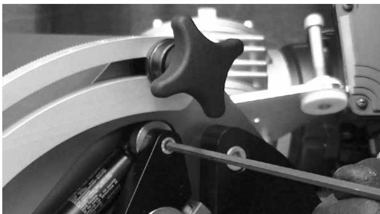
Para ajustar el rodillo superior, afloje y retire el tornillo de fijación del resorte de gas.
