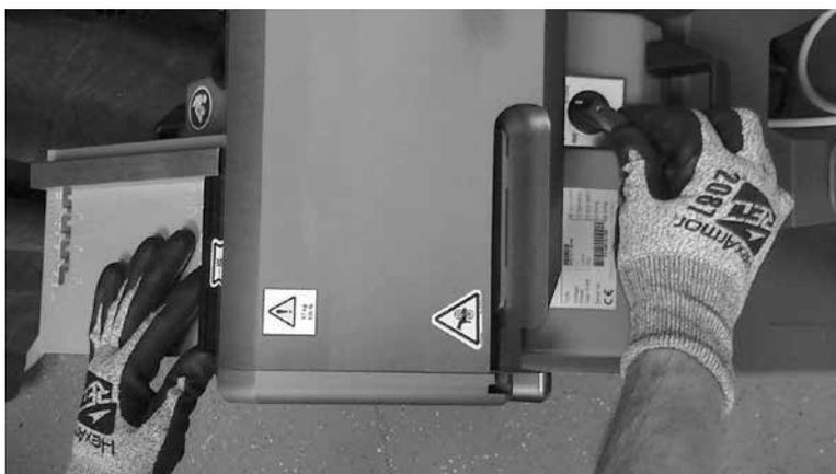
Vuelva a conectar el cable de energía al suministro de energía eléctrica. Gire el interruptor en 'REVERSA' para liberar la plantilla de calibración que está entre los rodillos de tracción.
