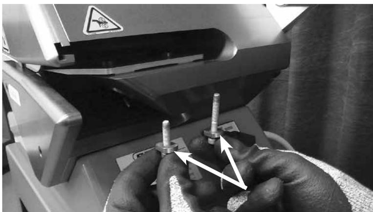
Asegúrese de que los espaciadores de latón estén colocados en el marco de Ply o en el tornillo. Apriete los tornillos solo con los dedos para que la hoja todavía pueda girar (el tornillo largo en la parte trasera y el tornillo corto adelante).
