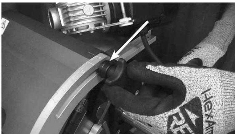
Coloque y bloquee la manija de ajuste para que los tornillos de ajuste estén accesibles.
