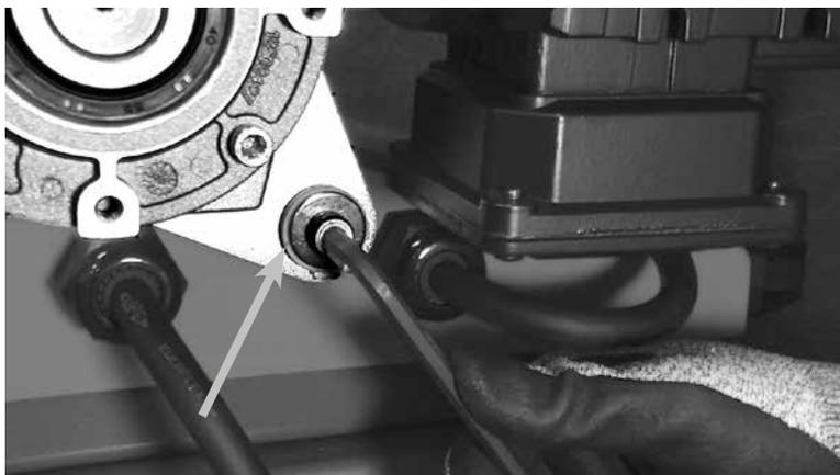
Quite el motor eléctrico para obtener suficiente acceso y ajustar los rodillos de tracción al quitar primero el tornillo del brazo de torsión con una llave hexagonal de 6 mm.
