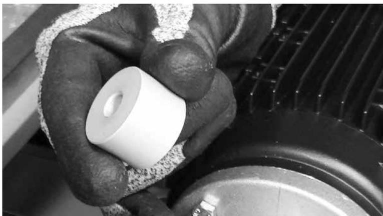
Después de quitar el tornillo del brazo de torsión, coloque el espaciador aparte.
