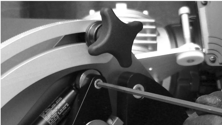
Zur Einstellung der oberen Rolle lösen und entfernen Sie die Befestigungsschraube der Gasfeder.
