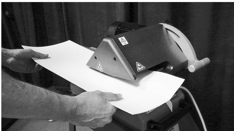
Führen Sie das Bandmaterial durch die Ply 130. Nach Ende der Aufspaltarbeiten den Betriebsschalter auf „OFF“ (Aus) stellen.
