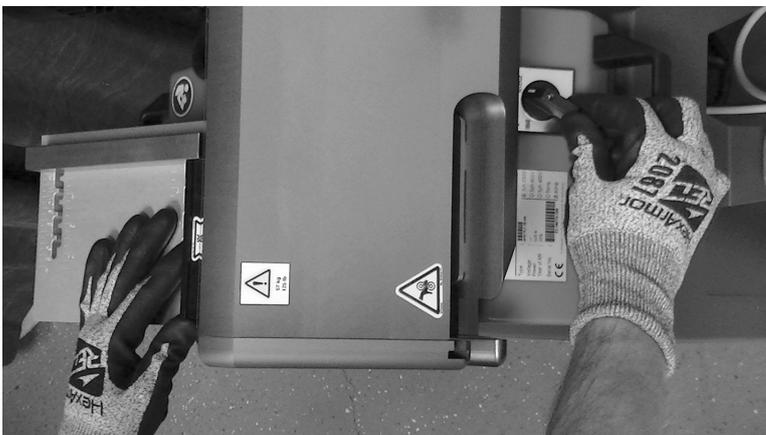
Schließen Sie das Netzkabel wieder an die Spannungsversorgung an. Drehen Sie den Schalter auf „REVERSE“ (Rückwärts), um die Distanzlehre aus der Maschine zu fahren.
