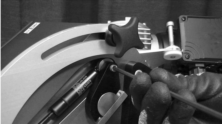
Die Schraube der Gasfeder wieder einbauen.
