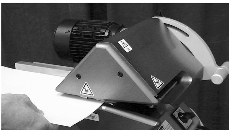
Setzen Sie ein Musterstück des Bands mit der Belagseite nach unten auf die Bandstützplatte. Lassen Sie das Band durch die Spaltmaschine laufen.
