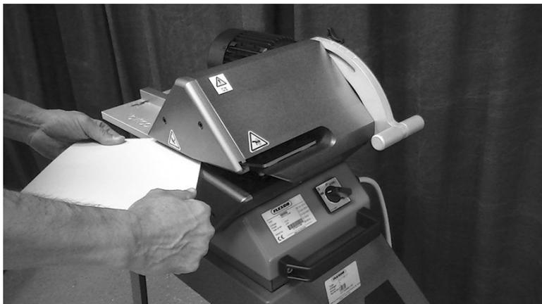
Mit einem Musterstück des Bandmaterials die Spaltdicke zwischen den Lagen überprüfen. Stellen Sie den Einstellgriff nach Bedarf ein (C2). Bei sehr großer Spalttiefe wird empfohlen, sich in mehreren Durchgängen an die Endtiefe anzunähern.
