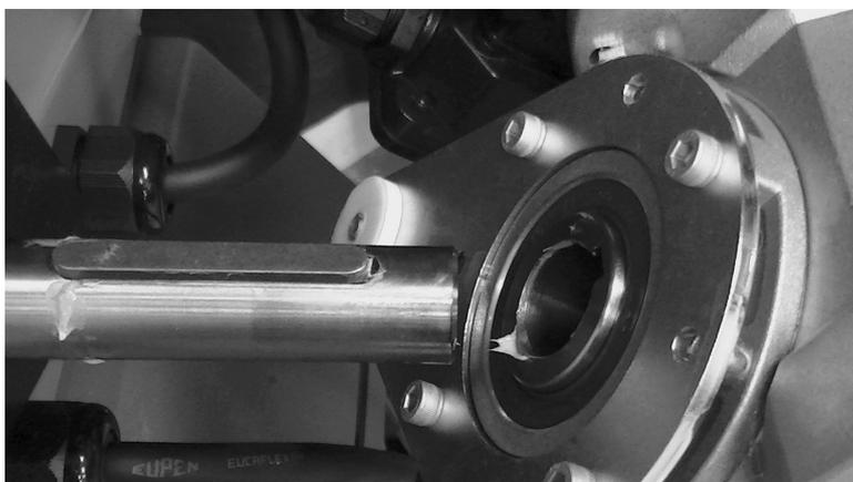
Den Motor wieder einbauen. Die Passfeder mit der Nut an der Welle ausrichten.
