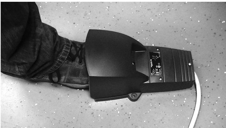
Setzen Sie die Traktionsrollen in Vorwärtsrichtung durch Betätigen des Fußpedals in Gang.
