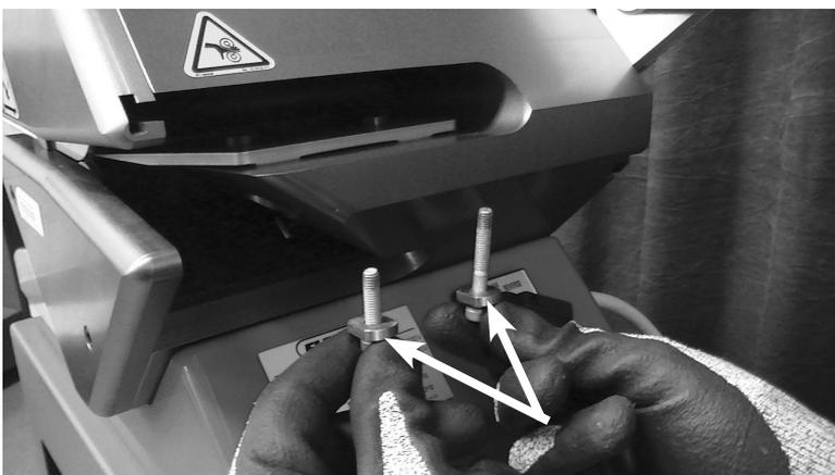
Stellen Sie sicher, dass die Messing-Distanzstücke entweder am Rahmen der Maschine oder an den Schrauben vorhanden sind. Ziehen Sie die Schrauben von Hand fest, sodass sich die Klinge noch bewegen kann (lange Schraube hinten, kurze Schraube vorne).
