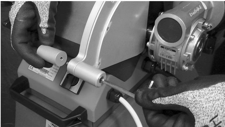
Mit einem 5-mm-Inbuschlüssel entfernen Sie den Griff.
