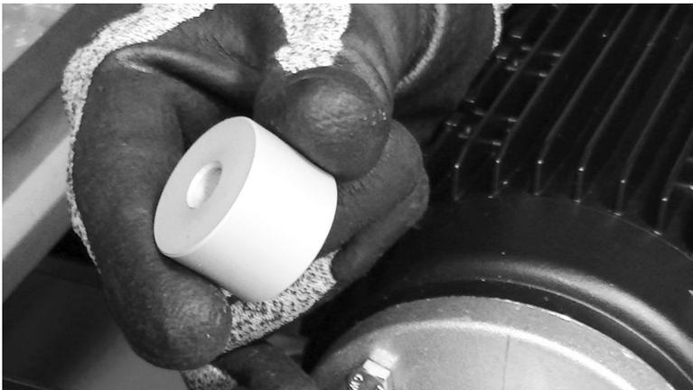
Nach dem Entfernen der Spannarmschraube legen Sie das Distanzstück beiseite.
