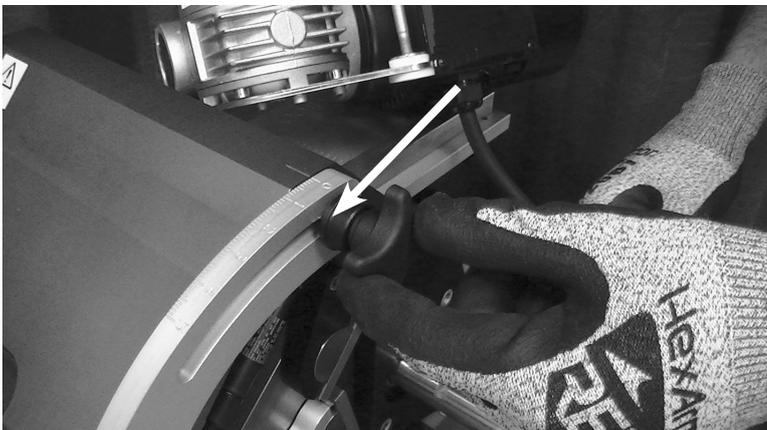
Den Einstellgriff so positionieren und arretieren, dass die Einstellschrauben zugänglich sind.
