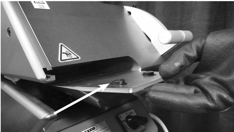
Setzen Sie die Muttern so ein, dass die An­schrägung in Richtung der Traktionsrollen zeigt.
