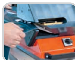
Separe hasta 5" (130 mm) en un solo paso para la preparación perfecta de los empalmes graduales y las grapas mecánicas empotradas
