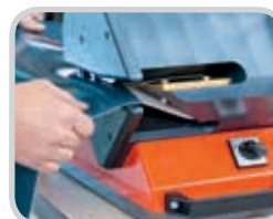
Separe hasta 130 mm (5") en un solo paso para la preparación perfecta de los empalmes graduales y las grapas mecánicas empotradas
