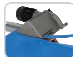
El cortador de paso opcional prepara las bandas al quitar rápidamente la capa superior con un corte vertical y horizontal simultáneo.
