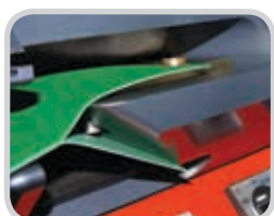
Separación exacta entre bandas, con cortes tan delgadas como 0.35 mm (0.014")
