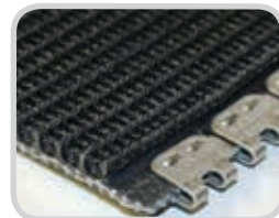
可以更加方便地为嵌入 式带扣安装准备输送 带末端
