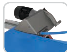
可以选配搭接切割机， 通过垂直和水平方向的 同步切割快速去除顶 层，以准备输送带
