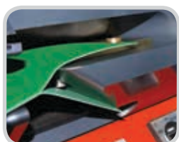
准确分离输送带， 分离后的薄片可薄至 0.35 mm (0.014")
