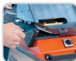
单次操作可一次性分离多达 130 mm (5")，这使得该工具成为 搭接准备和嵌入式机械带扣安装 的完美选择
