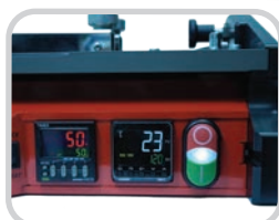
Có thể sử dụng Thiết lập làm nóng trước để loại bỏ độ ẩm và tránh bị lỗ kim
