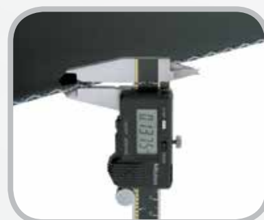
Mida el espesor de la banda.
