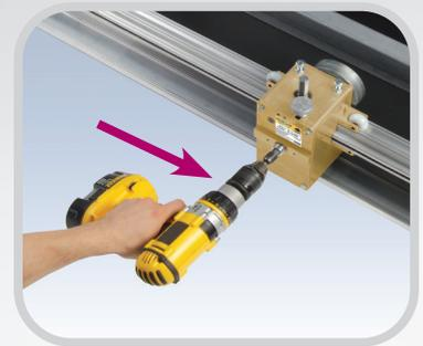
*Der Antriebskopf der Einpressmaschine wird mit einer 18-Volt-Akkubohrmaschine angetrieben, das macht die Montage schneller und bedeutet weniger Arbeitsaufwand für den Monteur. (Bohrmaschine nicht im Lieferumfang der Einpressmaschine enthalten.)*
