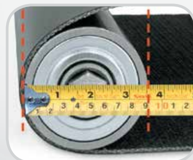
测量最小滚筒直径。
