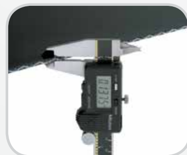
测量输送带厚度。
