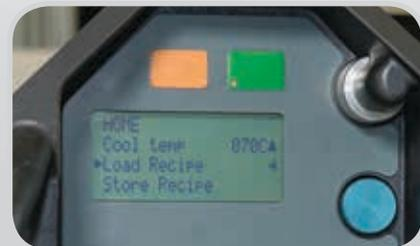
加载保存的拼接程序可确保无论哪一位技师操作热压机，都能一如既往地获得高质量的拼接效果。
