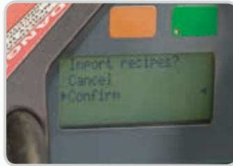
Aero® 的一个独有功能是能够在热压机上存储 1,000 多个拼接程序。
