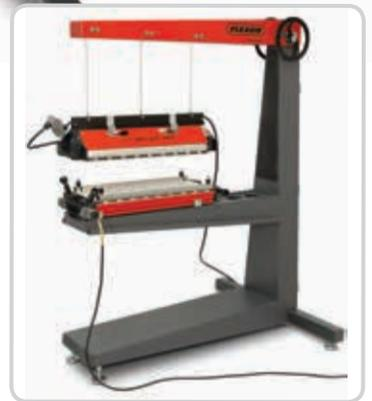
为方便在车间内的搬运，特为宽度为 625、925 和 1225 的热压机推出了 Aero® 车间支架。使用支架可以帮助车间提高工作效率，且操作人员可以从支架上轻松拆下热压机以便在工作地点使用。
