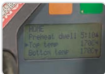
可以独立设置顶部和底部加热元件的温度来确保最优拼接效果。
