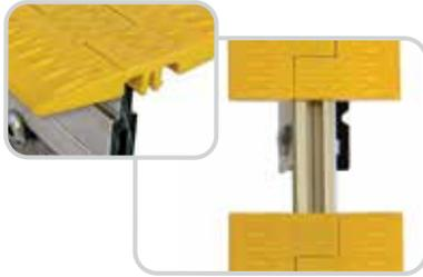
Las pestañas elevadas ayudan a reducir la fricción en la superficie en las transiciones más cortas: especialmente importante para la consistencia en el espaciado dosificado cuando se transportan paquetes y cajas más livianas.
