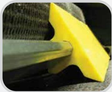
**Diseño de ajuste a presión:** los segmentos de 76.2 mm están diseñados para liberarse bajo presión si se atorán objetos pequeños entre la banda y los segmentos.
