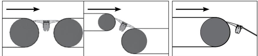
**Para aplicaciones de banda horizontal a banda horizontal.** Mida la distancia entre las poleas en un punto no mayor al 25% del diámetro de la polea (incluyendo el espesor de la banda) desde la corona de ambas poleas.
