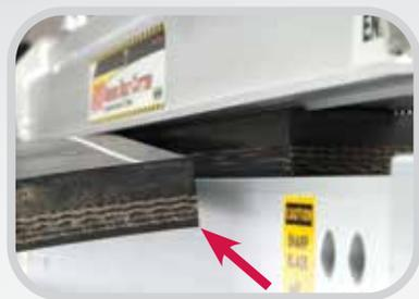
La característica de mordaza de lado individual permite que la banda de corte caiga libremente en un lado, eliminando la necesidad de que la hoja corte a través de dos superficies sujetas con mordaza, reduciendo así el esfuerzo del operador.
