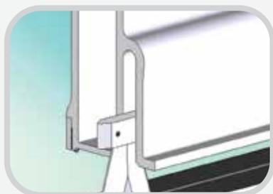
La parte superior de la hoja se captura dentro de la extrusión, garantizando que se logre un corte perpendicular.
