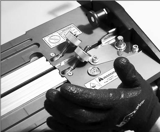
12. 移动固定压板，使其轻靠刀片固定装置。
