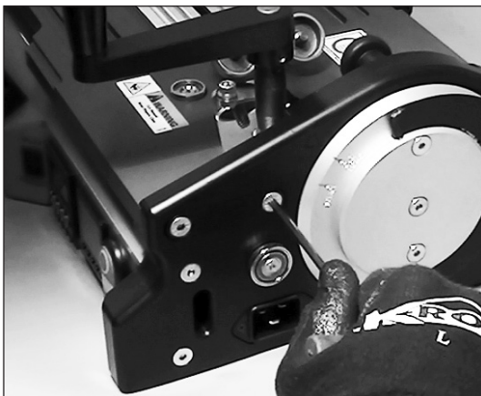
20. 完全拧紧两个 (2) 相邻的滑动压板锁定螺丝。
