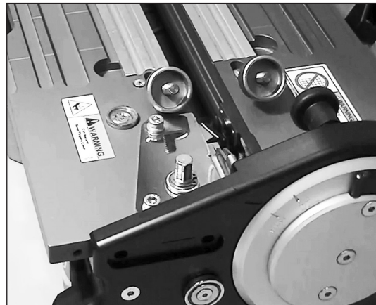
2. 将固定压板向后滑动到前压板保持槽。
