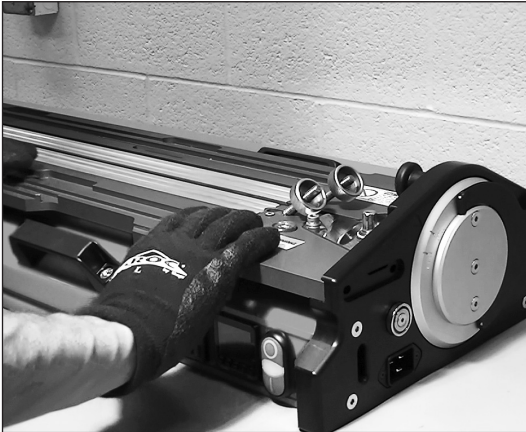
10. 将驱动盘锁定在切割/加载位置。
