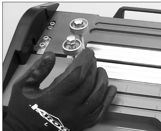
15. 移动固定压板，使其轻靠刀片固定装置。
