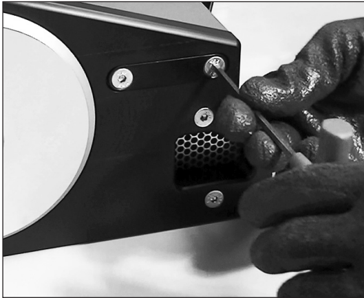
16. 完全拧紧两个 (2) 相邻的滑动压板锁定螺丝。
