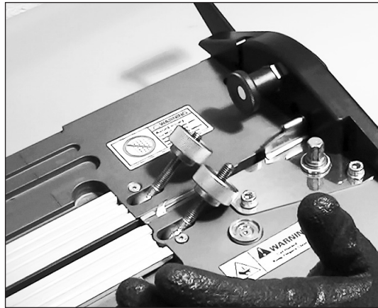
19. 确保固定压板轻靠刀片固定装置。
