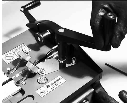
11. 转动曲柄，使刀片固定装置位于存放区域的外侧。
