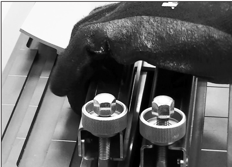
拆下夹杆和输送带。
