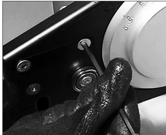
13. 略微拧紧两个 (2) 相邻的滑动压板锁定螺丝。
