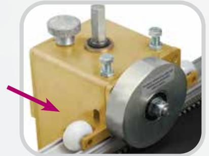
*El soporte de horquilla y los rodillos de guía proporcionan estabilidad adicional a la cabeza de la engrapadora y permiten un movimiento transversal con facilidad a lo ancho de la engrapadora. Los rodillos de guía están hechos de polietileno UHMW para una larga duración.*
