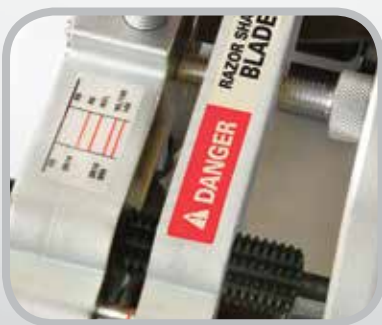
FSK™ 输送带去皮器的防护组件有塑料和金属两种材质供您选择，可用于在各种环境下调整去皮宽度。
