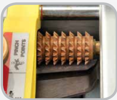
前端驱动托辊在去皮的开始处紧紧地抓住输送带以阻止其滑动。
