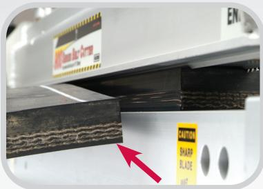
*Односторонний зажим для свободного падения отрезанной части ленты с одной стороны. При этом исключается необходимость прохождения режущего лезвия через две скатые поверхности, что уменьшает усилие, прикладываемое пользователем.*
