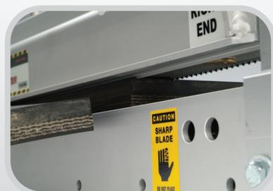
*Une barre inférieure bombée et une surface adhérente avec de légères dentelures fournissent une force de serrage maximum : la lame coupe la bande avec une grande précision.*
