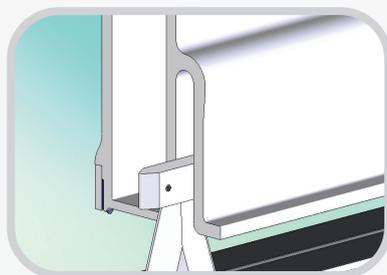
*Le sommet de la lame robuste est capturé dans l'extrusion, ce qui assure une coupe perpendiculaire.*
