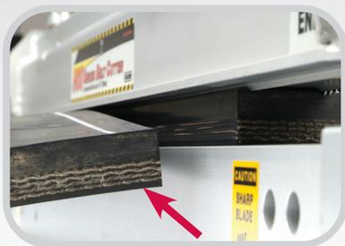
*La pince simple face permet à la bande coupée de tomber librement d'un côté : il n'est plus nécessaire que la lame coupe dans deux surfaces serrées, ce qui réduit l'effort fourni par l'opérateur.*
