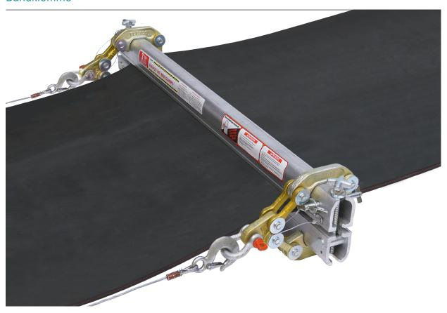
Die Klemmbalken des Far-Pul™ HD® werden aus wärmebehandeltem Aluminiumprofil hergestellt, so dass diese korrosionsbeständig sind und in nassen oder Korrosion begünstigenden Umgebungen nicht festfressen. Die Far-Pul™ HD® Bandklemmen sind mit verstellbaren Klemmschrauben aus Stahl ausgerüstet.
