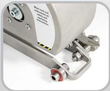
Das selbausgleichende Schienenführungssystem bietet während des Einsatzes zusätzliche Stabilität, um einen geraden, exakten Schnitt zu ermöglichen.
