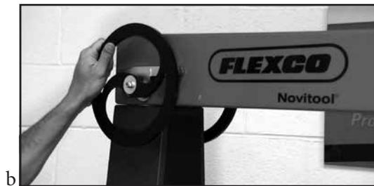
Rad in Richtung Anheben der Gegengewichte drehen, was zu einem weiteren Absenken des oberen Pressbalkens führt. Üblicherweise reichen ca. 2-3 „Klickgeräusche“ des Klauenhebels aus, um das Gegengewicht vollständig zu entlasten.
